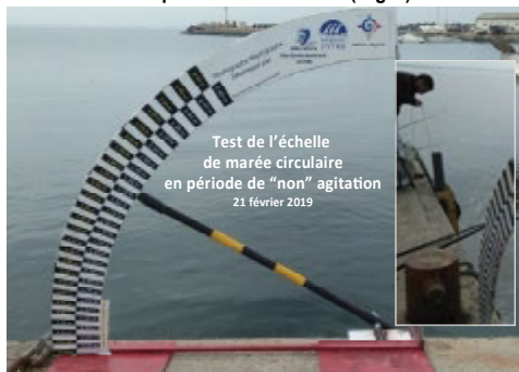
Premier prototype de l'échelle de marée circulaire installée au port de Tamentfoust (Alger)
