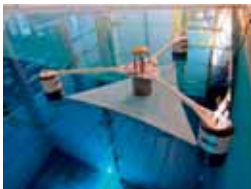
Figure 3: La photo de gauche est la dernière version du prototype de bouée GPS développée par la division technique de l'INSU à Brest et utilisée à la fois pour l'étalonnage des marégraphes côtiers et des missions altimétriques. Les courbes de la figure du milieu montrent un exemple de détection d'une erreur d'échelle « classique » d'un marégraphe grâce à l'utilisation du test de Van de Graaf. La courbe de droite illustre la complexité du dispositif d'étalonnage des missions d'altimétrie satellitaire qui nécessitent une détermination précise et absolue des références verticales.
