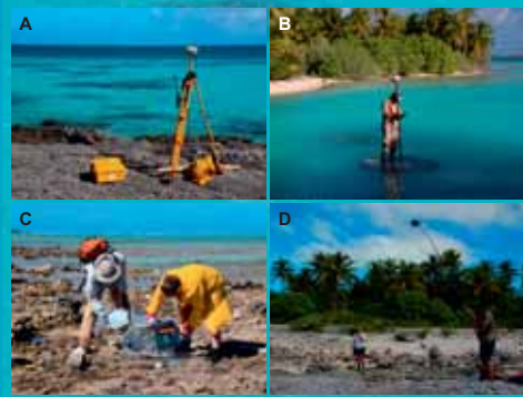
Fig. 4: Méthodologie. A + B: La base et l'appareil mobile du système GPS Trimble R8 RTK (Real Time Kinematic) pour enregistrer la position des échantillons avec une précision verticale et horizontale de ± 2.5 cm et quelques millimètres, respectivement. C: Échantillonnage des colonies coralliennes pour l'analyse paléoclimatique au moyen d'une scie circulaire. D: Prise de photos pour générer les cartes 3D.
