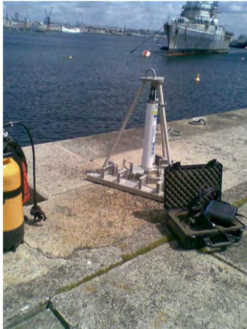
FIGURE E.1 – Marégraphe plongeur mouillé à proximité de la digue Ouest de Brest
