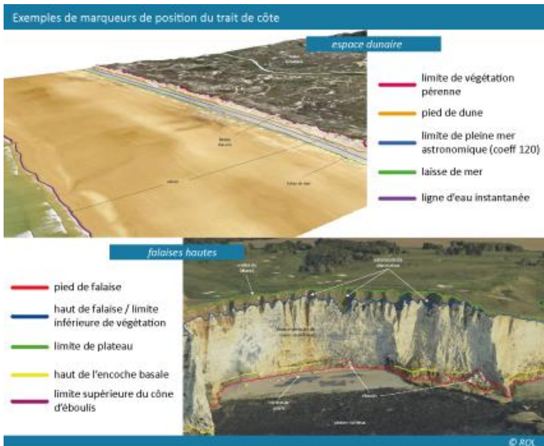
Figure 1 - Exemples de marqueurs de position du trait de côte sur un espace dunaire, une côte à falaise, un estuaire et une zone urbanisée (Source : ROL Application Trait de Côte)
